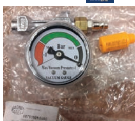
Generator próżni z manometrem (zweźka Venturiego)
